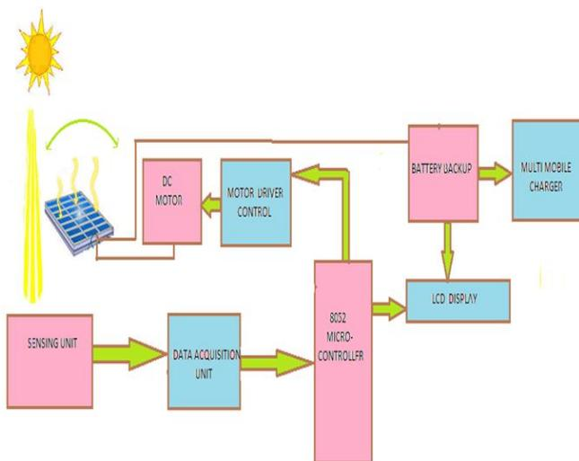
**FIGURE 2** BLOCK DIAGRAM OF SOLAR POWER SYSTEM FOR MMC
